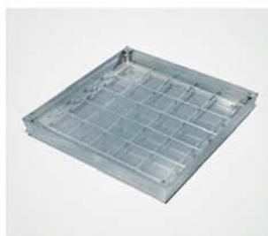
odori. Il telaio viene fissato tramite gettata a livello del pavimento. Successivamente la vasca può essere riempita ed inserita nel telaio. Per il montaggio, il coperchio viene fissato al telaio tramite viti di serraggio, che grazie all'apposita chiave di sollevamento in dotazione può essere rimosso. Il riempimento della vasca è possibile con pavimentazione in pietra, piastrelle, cemento, resina, granito, legno e pavimenti duri o altri materiali.
