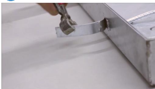
Sia su chiusini in acciaio inox che in acciaio zincato, piegate le zanche, in modo tale da garantire una completa stabilità di ancoraggio nella gettata.
