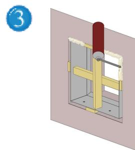
Inserite nella fessura tra il telaio e la muratura la schiuma poliuretanicca e lasciatela asciugare per il tempo indicato sulle istruzioni fornite dal produttore.
