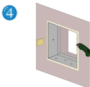
Dopo l'asciugatura della schiuma rimuovete i cunei e i traversi e asportate la parte di schiuma eccedente.
