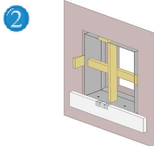
Prendete il telaio esterno della botola e inseritelo nel foro. Con l'aiuto di una livella a bolla, puntate il telaio, fissatelo con dei cunei e inserite dei traversi orizzontali e verticali. Fate attenzione alla direzione di apertura: i click clack devo essere sulla parte superiore.
