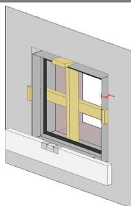
Prendete il telaio esterno della botola e inseritelo nel foro. Con l'aiuto di una livella a bolla, puntate il telaio, fissatelo con dei cunei e inserite dei traversi orizzontali e verticali. Fate attenzione alla direzione di apertura: i click clack devo essere sulla parte superiore.
