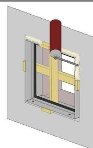
Inserite nella fessura tra il telaio e la muratura la schiuma poliuretanicca e lasciatela asciugare per il tempo indicato sulle istruzioni fornite dal produttore.
