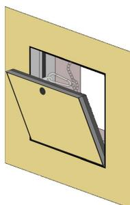
Utilizzate per finitura dell'impregnante o un primer per esterni. Inserite lo sportello con i perni verso il basso nei fori corrispondenti sul telaio esterno. Agganciare il cavetto di sicurezza e chiudere la botola. Riagganciare il cavetto di sicurezza dopo ogni apertura.
