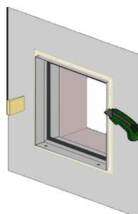
Dopo l'asciugatura della schiuma rimuovete i cunei e i traversi e asportate la parte di schiuma eccedente.
