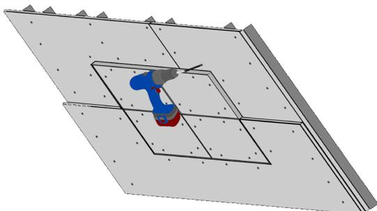
Nella chiusura del controsoffitto potete fissare le lastre direttamente al telaio esterno, sfalzando le giunte se è in doppia lastra, altrimenti prima di fissare la lastra singola spessorate con una striscia di cartongesso da 12,5 il telaio esterno della botola.
