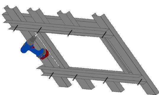
Avvitare nella sottostruttura del soffitto, due profili a U opposti in modo tale che sporgano almeno 2 cm nell'apertura. Questi serviranno come ausilio per assicurare un montaggio ad incasso semplice.
