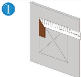
Misurate il telaio esterno e con l'ausilio di una falsa squadra disegnate il profilo dell'apertura sulla parete o soffitto in cui andrà collocata la botola.
