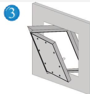
Prendete la botola d'ispezione e facendola ruotare inserita in diagonale attraverso l'apertura praticata.
