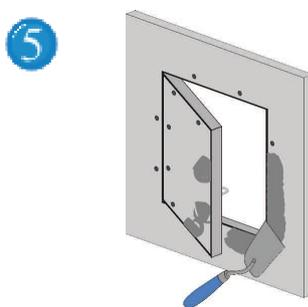
Stuccate ora il contorno del telaio esterno alla parete / soffitto di gesso rivestito, incluse le viti. Successivamente stuccate anche lo sportello.
