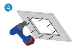
Premete il telaio esterno contro il soffitto dal retro e fissatelo con viti autofilettanti ad una distanza massima tra loro di 13 cm.
