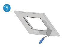
Stuccate ora il contorno di entrambi i telai al soffitto di gesso rivestito, incluse le viti.
