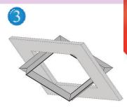
Misurate il telaio esterno e con l'ausilio di una falsa squadra disegnate il profilo dell'apertura sul soffitto in cui andrà collocata la botola.
