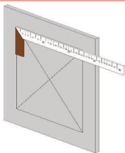
Misurate il telaio esterno e con l'ausilio di una falsa squadra disegnate il profilo dell'apertura sul soffitto in cui andrà collocata la botola.
