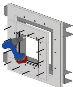
Togliete lo sportello dalla botola d'ispezione e premete il telaio esterno dalla parte anteriore contro i profili a C. Durante il montaggio fate attenzione che i click clack devono trovarsi sulla parte superiore. Fissate il telaio esterno ai profili a C con viti autopercoranti ad una distanza massima di 13 cm.
