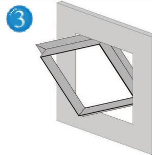
Prendete il telaio esterno della botola d'ispezione e facendolo ruotare inseritelo in diagonale attraverso l'apertura praticata. I click clack devono trovarsi sulla parte superiore.
