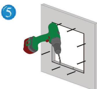
Con una punta  $\varnothing$  6 mm forate la lastra di gesso rivestito per ca. 1 cm attraverso i fori presenti nel telaio esterno, affinché questi possano alloggiare i perni dello sportello.
