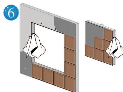
Applicate la colla per piastrelle a filo del telaio dello sportello e del telaio sulla parete, lasciando entrambi i telai a vista e fissate le piastrelle. Pulite infine entrambi i telai da eventuali residui. Questo è fondamentale affinché non venga compromessa la funzionalità della botola d'ispezione.
