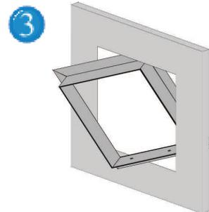
Prendete il telaio esterno della botola d'ispezione e facendolo ruotare inseritelo in diagonale attraverso l'apertura praticata. Fate attenzione che i click clack devono trovarsi sulla parte superiore.
