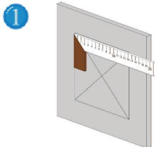
Misurate il telaio esterno e con l'ausilio di una falsa squadra disegnate il profilo dell'apertura sulla parete in cui andrà collocata la botola.
