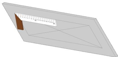
Misurate il telaio esterno e con l'ausilio di una falsa squadra disegnate il profilo dell'apertura sul soffitto in cui andrà collocata la botola.
