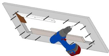
Premete il telaio esterno contro la parete dal retro e fissatelo al soffitto di gesso rivestito con viti autofilettanti ad una distanza massima tra loro di 17 cm.
