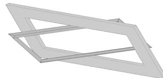
Prendete il telaio esterno della botola d'ispezione e facendolo ruotare inseritelo in diagonale attraverso l'apertura praticata. In caso di applicazione a parete fate attenzione che i click clack devono trovarsi sulla parte superiore.
