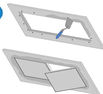
Stuccate ora il contorno del telaio esterno al soffitto di gesso rivestito, incluse le viti. Successivamente stuccate anche gli sportelli.
