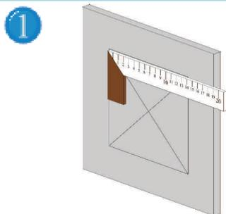
1 Misurate il telaio esterno e con l'ausilio di una falsa squadra disegnate il profilo dell'apertura sulla parete o soffitto in cui andrà collocata la botola.
