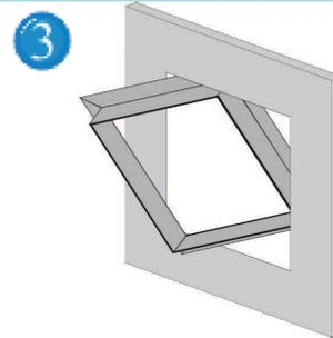
3 Prendete il telaio esterno della botola d'ispezione e facendolo ruotare inseritelo in diagonale attraverso l'apertura praticata. In caso di applicazione a parete fate attenzione che i click clack devono trovarsi sulla parte superiore.
