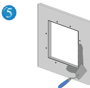
5 Stuccate ora il contorno del telaio esterno alla parete / soffitto di gesso rivestito, incluse le viti. Se necessario stuccate anche lo sportello.
