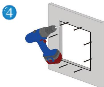
4 Premete il telaio esterno contro la parete dal retro e fissatelo alla parete / soffitto di gesso rivestito con viti autofilettanti ad una distanza massima tra loro di 17 cm.
