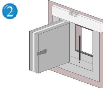
Prendete la botola con lo sportello aperto e inseritela nel foro. Con l'aiuto di una livella a bolla, controllate il posizionamento e segnate la posizione del foro con l'ausilio di una matita. Estraiete di nuovo la botola.
