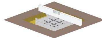
Posizionate il telaio esterno nel foro sul pavimento e verificate che sia a filo della pavimentazione esterna. Dovrebbe esserci minimo uno spazio di 100 mm da poter cementare.
