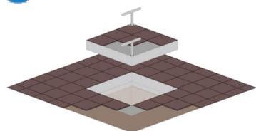
Dopo la completa asciugatura del cemento posizionate la pavimentazione esterna di finitura, sia nella vasca che all'esterno del telaio.
