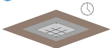
Riempite il chiusino con cemento totalmente o parzialmente a filo della pavimentazione di finitura. Cementate l'esterno del chiusino totalmente o a filo della pavimentazione. Fate attenzione a proteggere sia viti che profili dal cemento. non appena il telaio esterno ha fatto presa con il cemento non si potrà più spostare.
