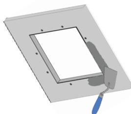
Stuccate ora il contorno del telaio esterno al soffitto di gesso rivestito, incluse le viti.
