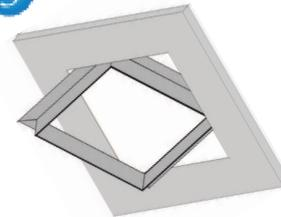
Prendete il telaio esterno della botola d'ispezione e facendolo ruotare inseritelo in diagonale attraverso l'apertura praticata.
