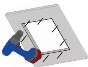
Premete il telaio esterno contro la parete dal retro e fissatelo al soffitto di gesso rivestito con viti autofilettanti ad una distanza massima tra loro di 17 cm.
