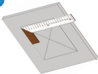
Misurate il telaio esterno e con l'ausilio di una falsa squadra disegnate il profilo dell'apertura sulla soffitto in cui andrà collocata la botola.
