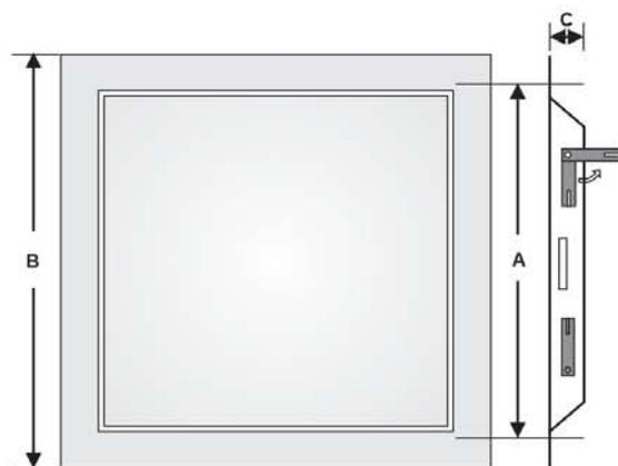
A = Foro muro (Foro Luce: A - 5 mm)
