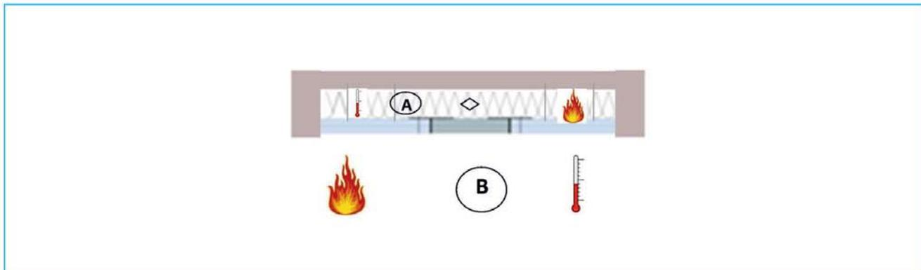
Il sistema F6 FF Systems per controsoffitto è stato progettato per essere inserito in controsoffitti a membrana e grazie al superamento di severi test antincendio, permette l'ispezione di tutto ciò che può esserci tra controsoffitto e solaio con la relativa resistenza al fuoco raggiunta.
